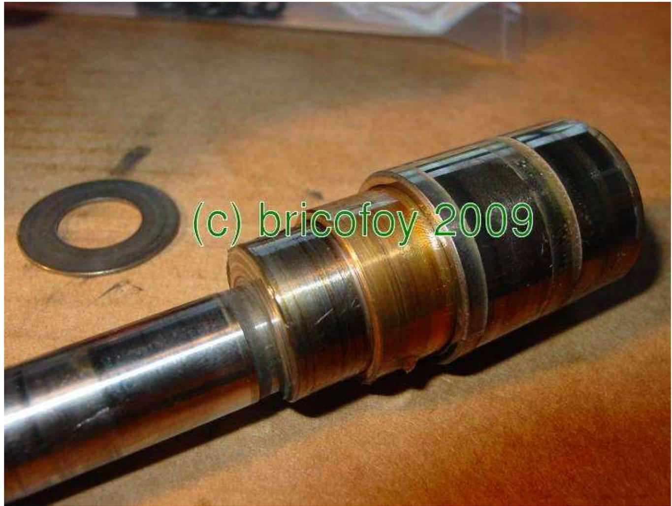
Puis la rondelle en bout d'arbre, avec toujours un peu de graisse ainsi que sur le bout de l'arbre :
