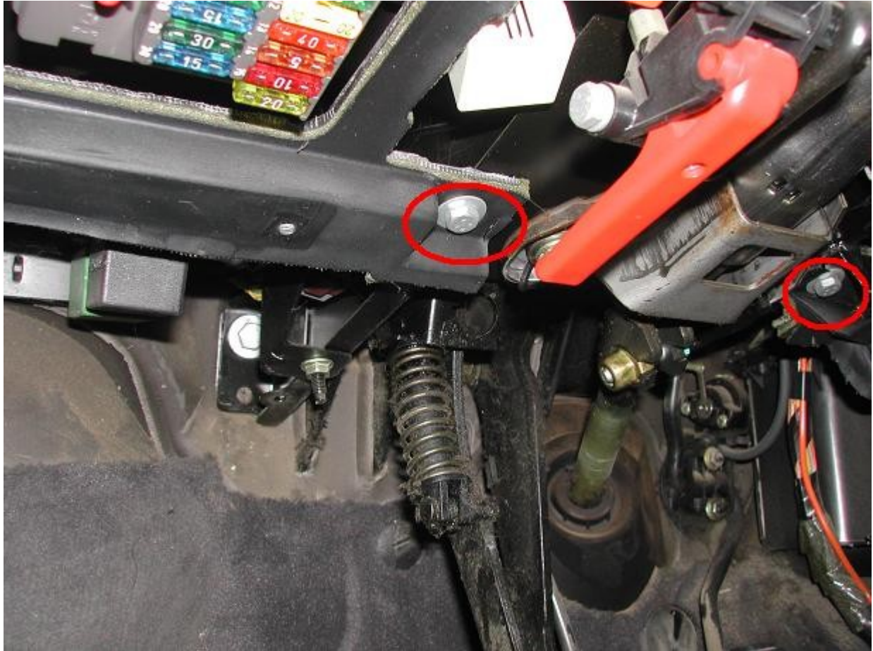
- 2 écrous de 13 à gauche du boîtier de fusibles
